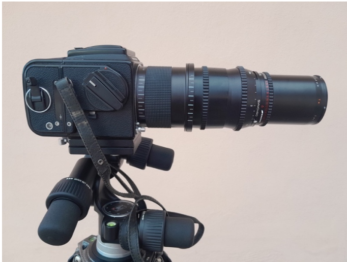
Hasselblad 500 CM con su montato il duplicatore Mutar 2x e il tele da 250mm. Come si vede l'estensione in avanti è piuttosto pronunciata.
